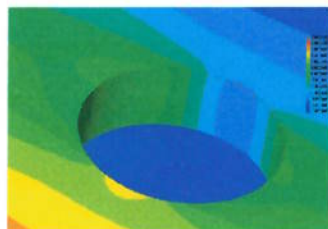
Figura 32 - tensões na direção X para momento +Y no engate F ,vista lateral esquerda
