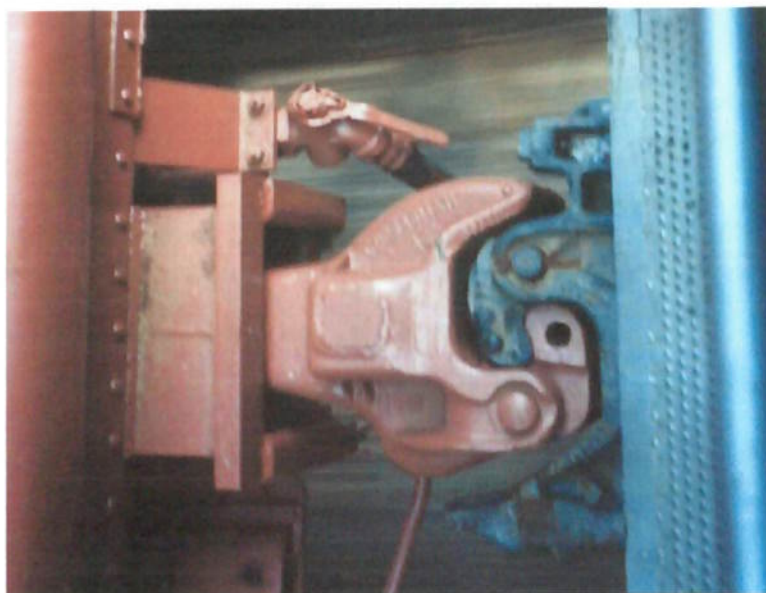
Figura 1 - engates ferroviários acoplados
